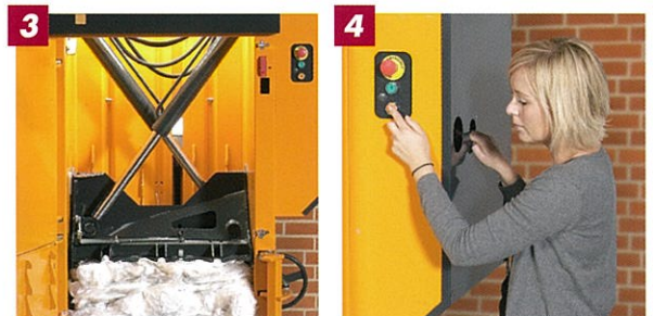
1 廃棄物の圧縮とベールの排出 2 ベールの搬出と保管 3 安定した圧縮と機械高さを抑えるクロスシリンダー方式 4 安全な両手押し操作によるベールの排出
